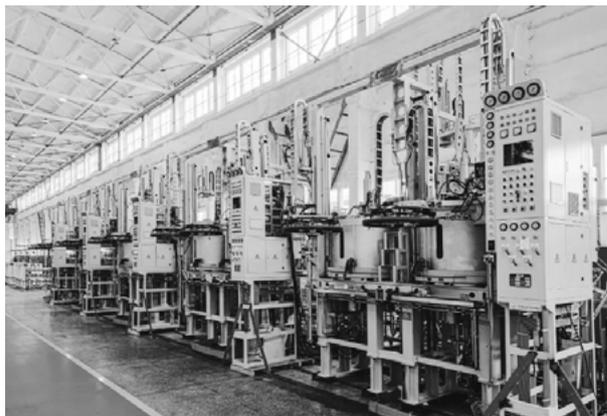
中化橡机研发生产的高等级乘用车子午线轮胎液压硫化机
