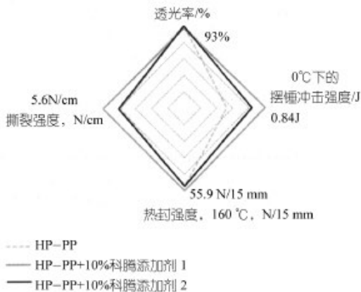
图5 显示未改性HP-PP和用10%两种不同类型的Kraton SBC聚合物添加剂改性的HP-PP的冲击强度、撕裂强度、热封强度和透光率的蜘蛛图
