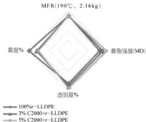
图3 显示未改性回收低密度聚乙烯薄膜和添加3wt%和5wt% CirKular+C2000改性薄膜的撕裂强度，MFR (190°C, 2.16kg) 和光学性能（雾度和透明度）的雷达图
