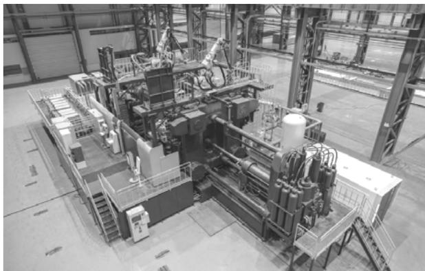
LEAP9000超大型压铸机
